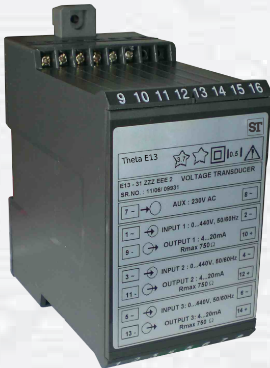
Fig. 1. Theta E13 clipped onto a top - hat rail.
